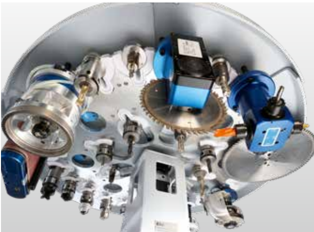
Magazzino circolare a 32 posizioni – disposizione degli utensili a doppio anello, interno ed esterno. Per utensili ed aggregati con un diametro fino a 200 mm ed una lama con un diametro fino a 350 mm (nell'anello esterno).
