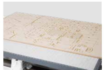
Piano Matrix Il piano Matrix, applicato sopra le ventose, permette di tagliare pezzi sagomati nel modo Nesting.
