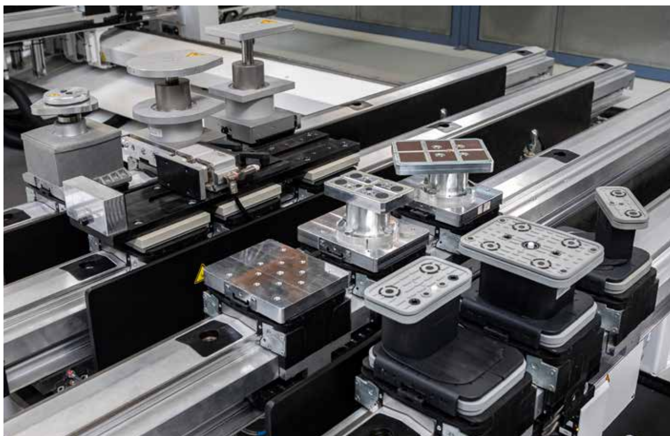
Dispositivo di bloccaggio a depressione con valvola tastatrice: le ventose non occupate possono rimanere sulla piastra base. Altezza 100 mm
