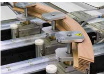
Pinze a 3 livelli: pinze a 3 livelli altamente rigide, con un campo di bloccaggio molto ampio consentono la lavorazione completa e precisa di finestre e porte senza successiva lavorazione delle battute.
