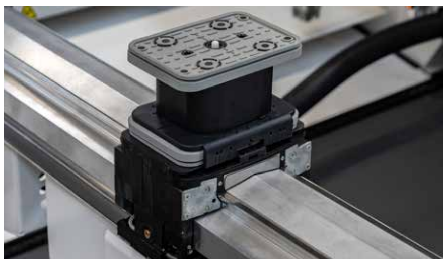
Dispositivo di bloccaggio a depressione con valvola tastatrice: le ventose non occupate possono rimanere sulla piastra base. Altezza 100 mm
