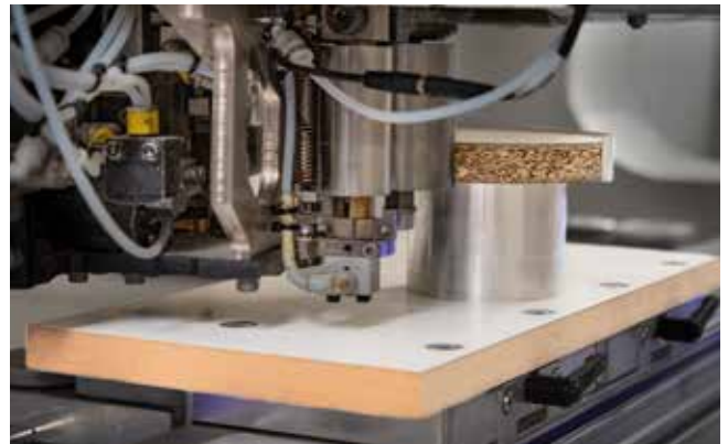
Incollaggio dei bordi a 360° con il gruppo di incollaggio powerEdge Pro Duo
