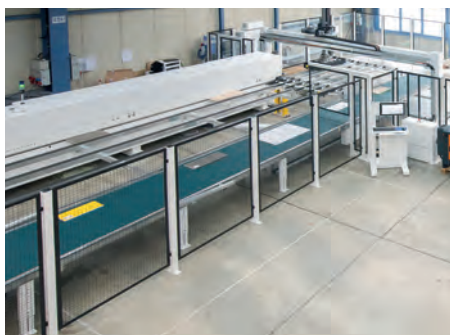
Dotazione per conformità CE: griglie di protezione lungo tutto il tratto di ritorno
