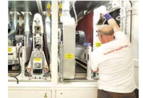
Bruno Wyler, GLAESER, bei der Bestückung der MFA Impression HEESEMANN Breitbandmaschine mit 1919 siawood+ Schleifbänder in TopTec-Technologie.
